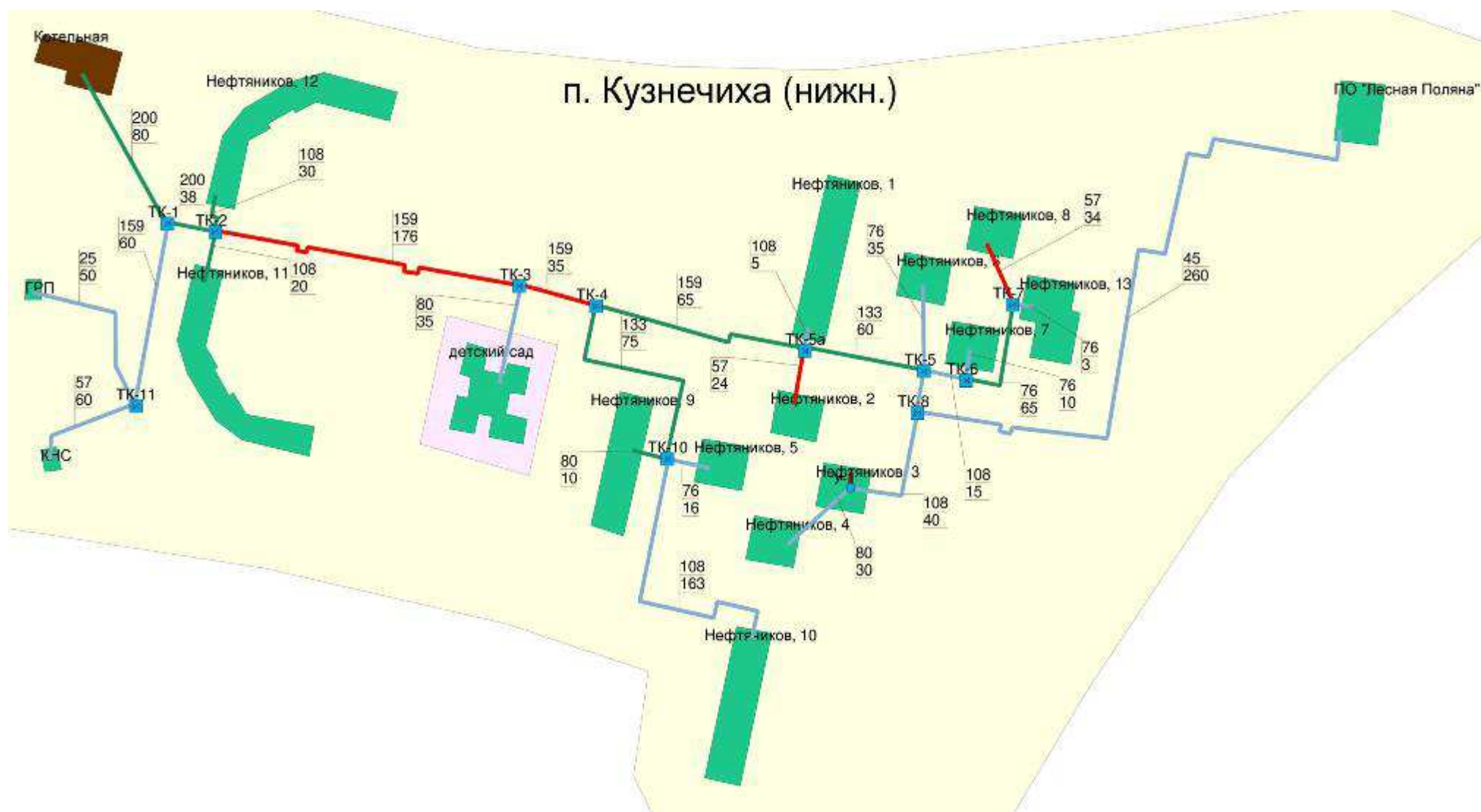
Рис. 8 Схема тепловых сетей котельной д. Кузнециха нижняя (отопление) в режиме наладки
